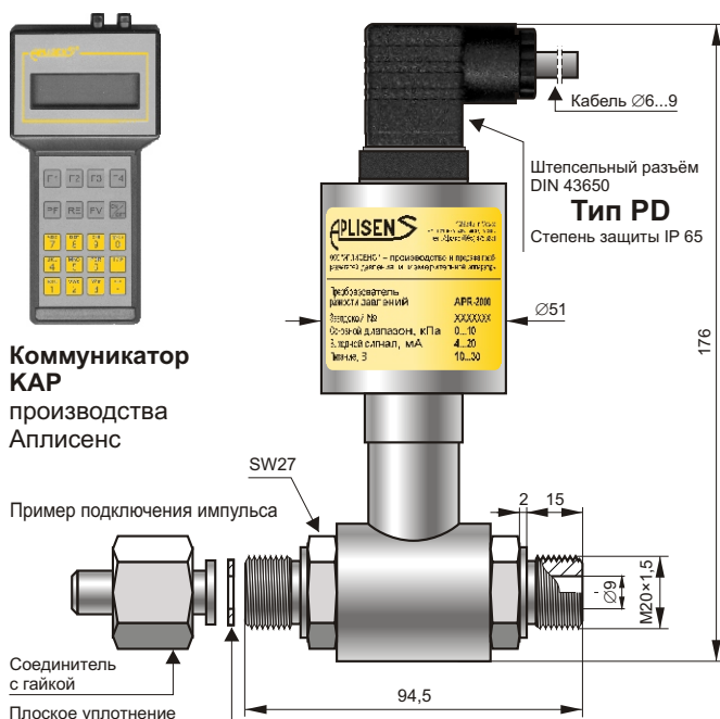
APR-2000PD с присоединительным устройством типа P (для подвода импульсных трубок) Предельно – допускаемое рабочее статическое давление 4 МПа
