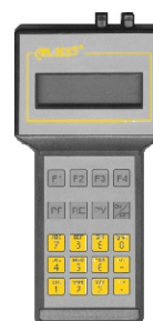
Коммуникатор КАР Производства Аплисенс
