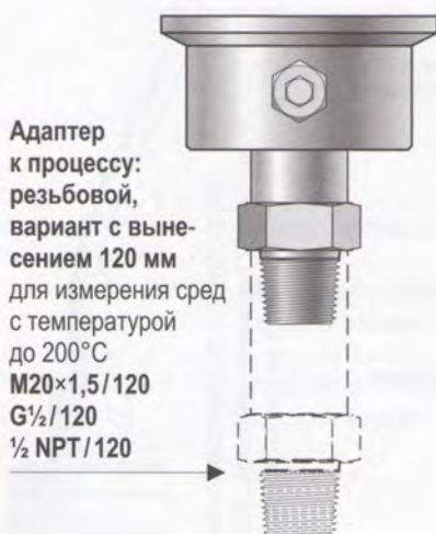
Адаптер к процессу: резьбовой, вариант с вынесением 120 мм для измерения сред с температурой до 200°C M20×1,5/120 G½/120 ½ NPT/120
