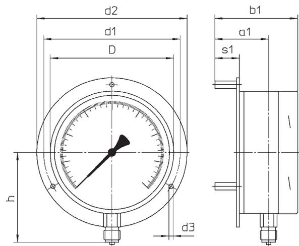
Die Gehäusebauform Fr wird mit am Gehäuse angeschweißten Laschen und losem Frontring geliefert.
