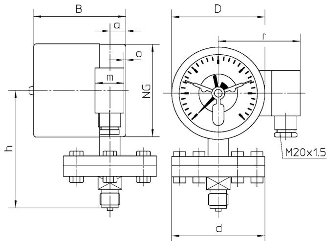
Манометры с пневматическими датчиками граничных сигналов (у манометров НД 100 размещение Blow-out на задней стенке корпуса не представляется возможным!)
