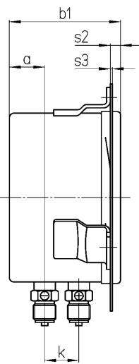
передний фланец жесткого крепления
